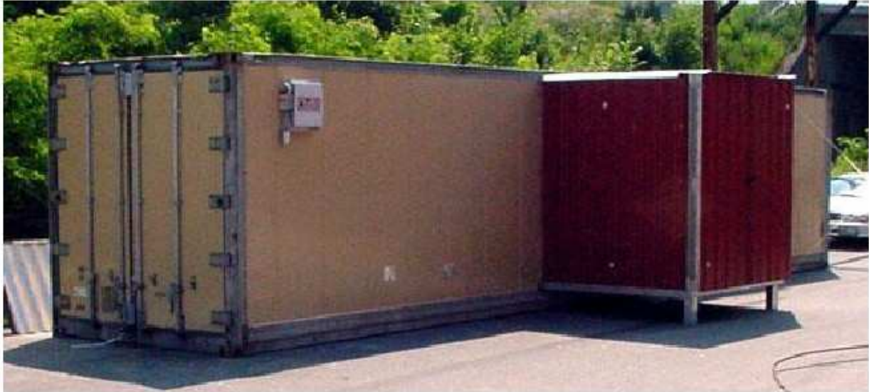
Horno Tipo Contenedor con Un Sistema Nyle L500 con Capacidad para 5,000 Pies Tablares
